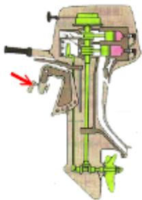
(B) 64 下圖中箭頭所指在二行程汽油引擎之名稱為何? (A)排氣孔 (B)掃氣孔 (C) 空氣及汽油混和 (D)廢氣
